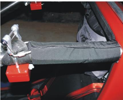
Im Anschluss um beide Tragegurte und Rohre die Manschetten anbringen.
