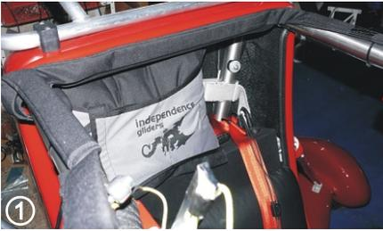
Der Container des Reservegerätes muss mit dem dahinter liegenden Trägerrohr durch Gurte fest verbunden werden.
