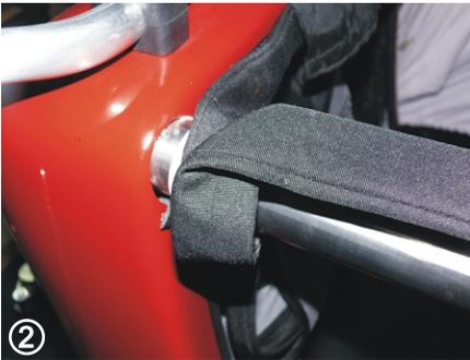
Beide Tragegurte nur wie in der Abbildung gezeigt **außerhalb** der Trägerrohre verlegen.
